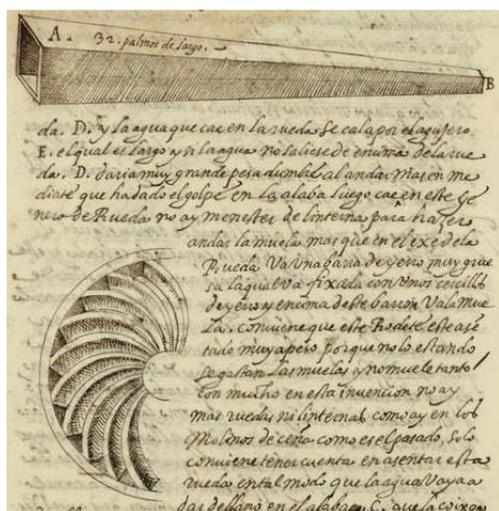
Fig 1: tubo lateral trapezoidal y rodete con álabes helicoidales. Fuente, Lastanosa, 1576, III, fol. 290v
