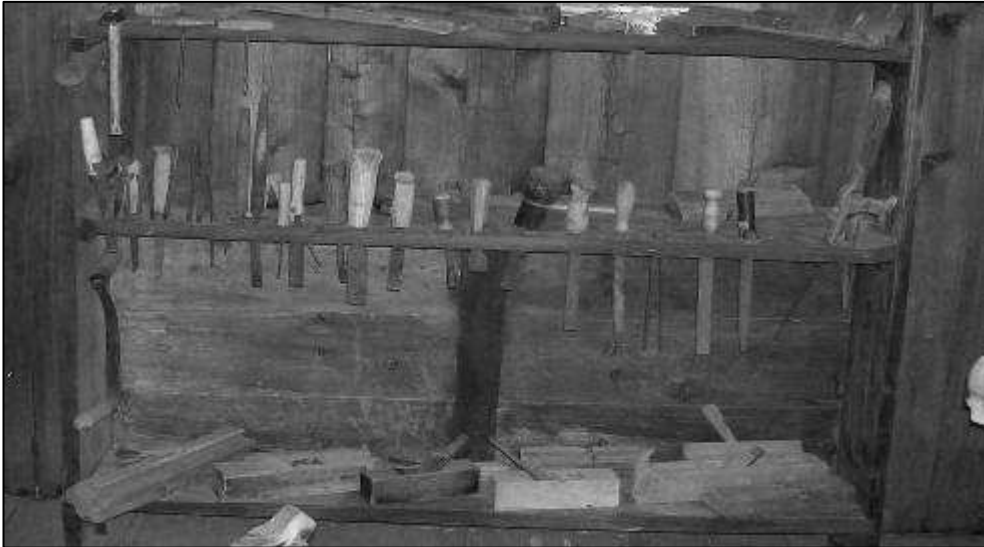
Fig. 7 - Gli attrezzi per la lavorazione del legno: pialle (in basso) e scalpelli (in alto). Fonte: Museo etnografico Petit-Monde , Comune di Torgnon (AO). Foto: E. Balbis (marzo 2009).
